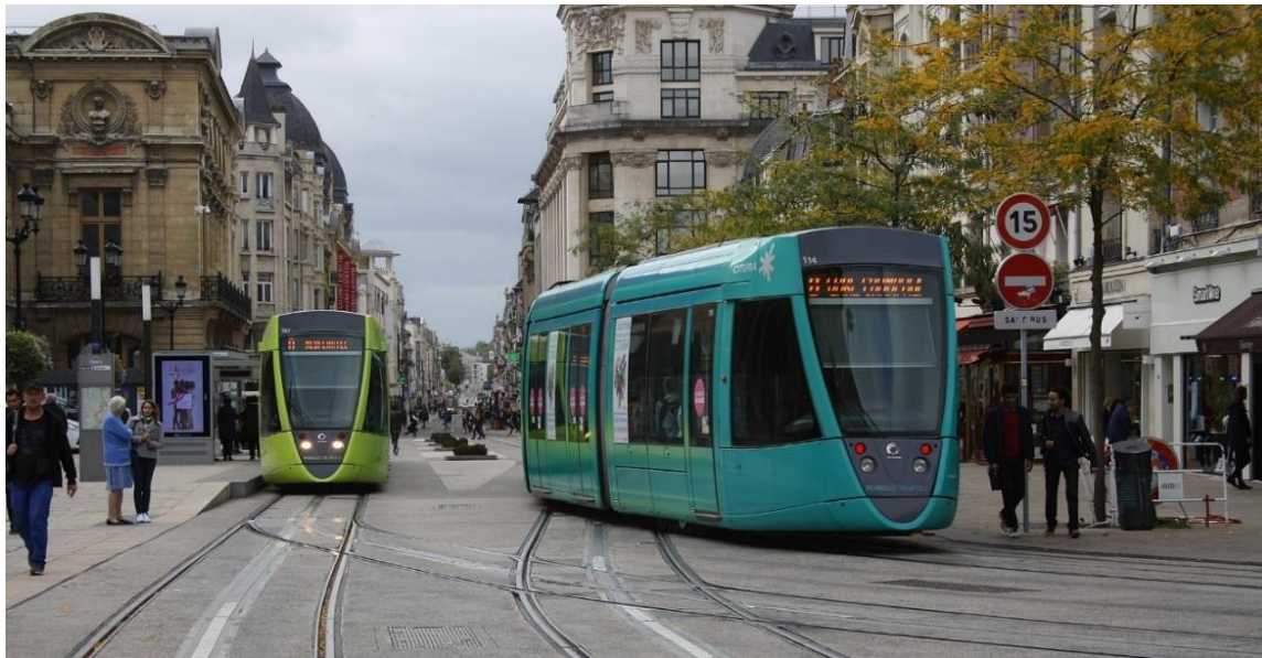
Weiche mit APS (Bodenstromversorgung) (Quelle: https://de.wikipedia.org/wiki/Stra%C3%9Fenbahn_Reims )
